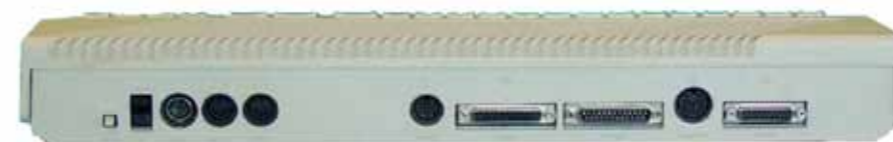
Utgångar för skärm, Centronics, RS232, MIDI, drivverk, hårddisk.
